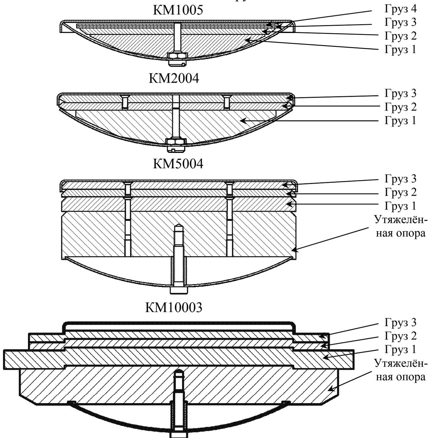
Рисунок 4.2 – Блоки и детали компаратора (балластные грузы и утяжеленные опоры)
