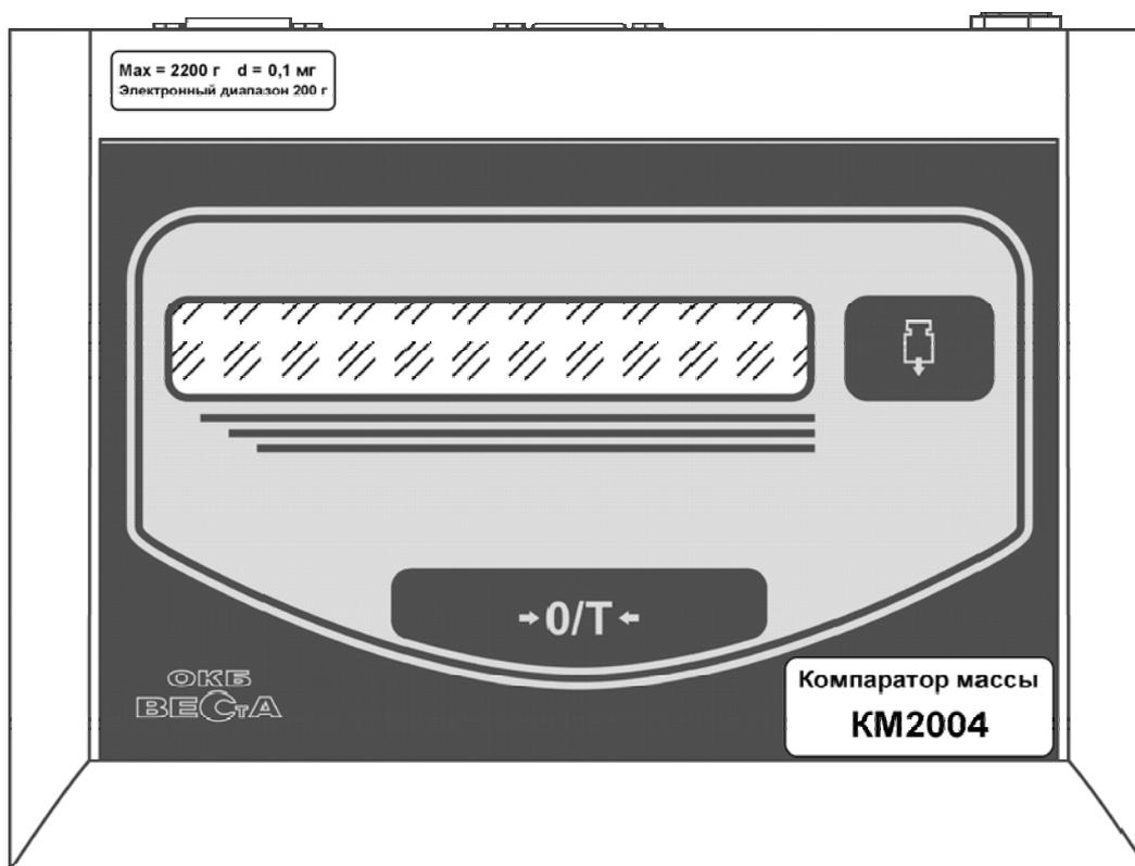
Рисунок 2 – Электронный блок
