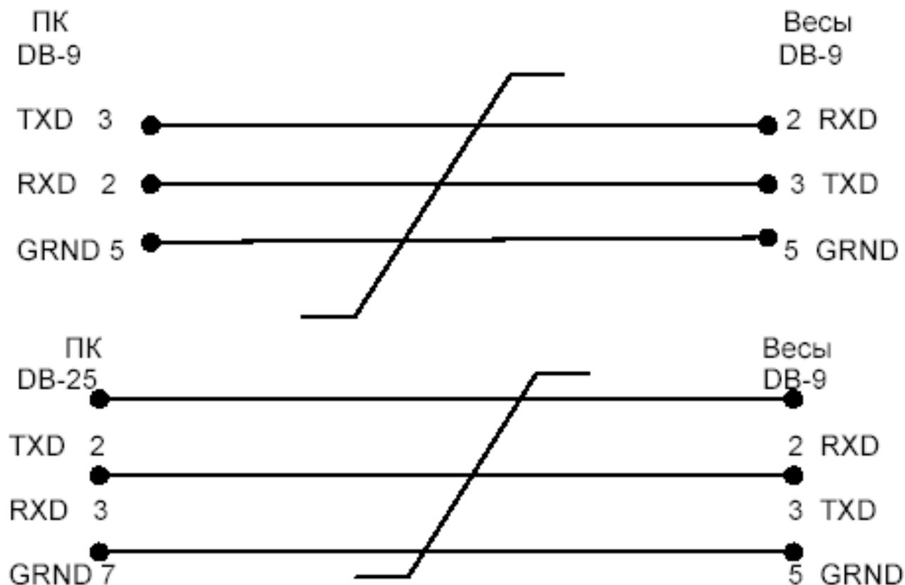
Рисунок 7 - Схемы подключения компаратора к компьютеру
