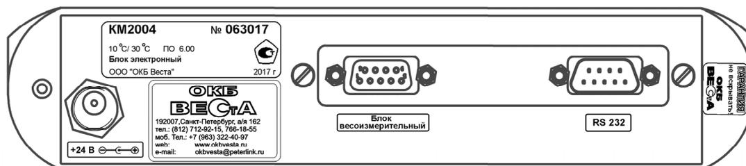
Рисунок 3 – Вид сзади блока электронного
